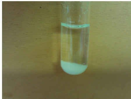
Abbildung 3: entstandener Niederschlag nach der Zugabe von Perchlorsäure
