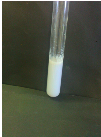
Abbildung 5: entstandener Niederschlag bei der Zugabe von silbernitrat-Lösung
