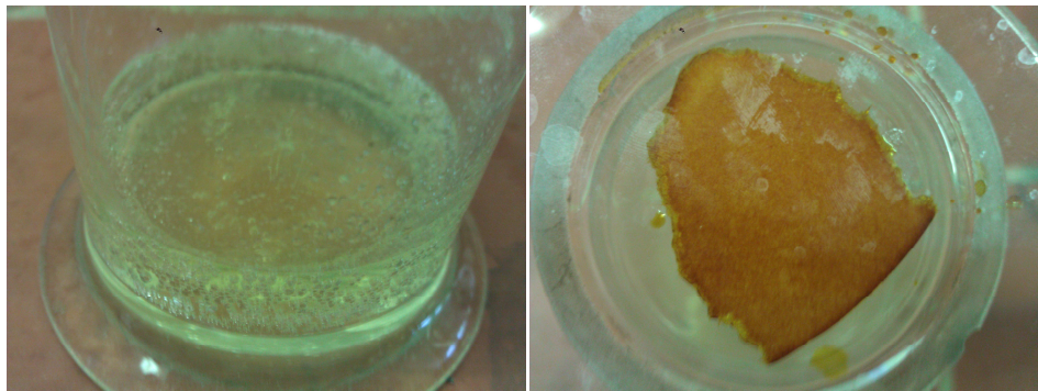
Abbildung 1: Gasentwicklung nach der Zugabe von Essigsäure (links), Verfärbung des Filterpapier (rechts)
