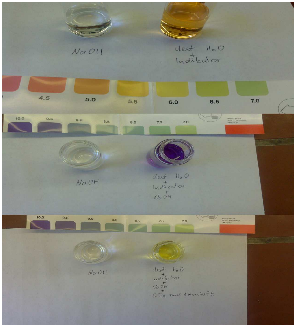
Abb. 3 – Oben: dest. Wasser und Indikator, Mitte: Natronlauge zugesetzt, Unten: Lösung nach durchpusten.
