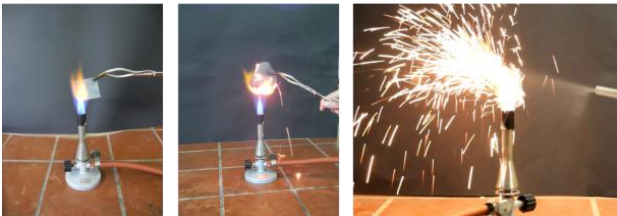
Abb. 1 – Die Oxidation von Eisenblech (links), Eisenwolle (mitte) und Eisenpulver (rechts).
