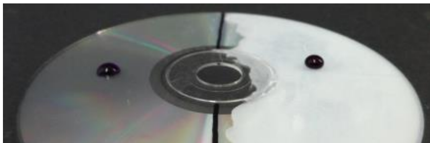
Abb. 1 – Lackmüstropfen auf einer unbehandelten (links) und einer mit Aceton behandelten CD (rechts).
