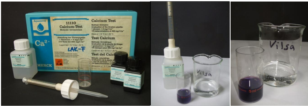
Abb. 4-6 – von links nach rechts: Calcium-Test Kasten, Probe Vilsa Naturelle mit Verbrauch Reagenz 3, Probe Vilsa Naturelle.
