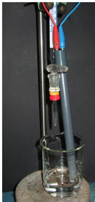
Abb. 1 – Aufbau Titration mit Leitfähigkeitsprüfer
