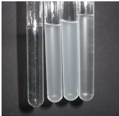
Abb. 3 – von links nach rechts: demineralisiertes Wasser, Vilsa Naturelle, Leitungswasser, Regenwasser.
