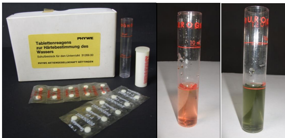
Abb. 7-9 – von links nach rechts: Phywe Testkasten, Probe mit Indikator vor Umschlag, Probe mit Indikator nach Umschlag.
