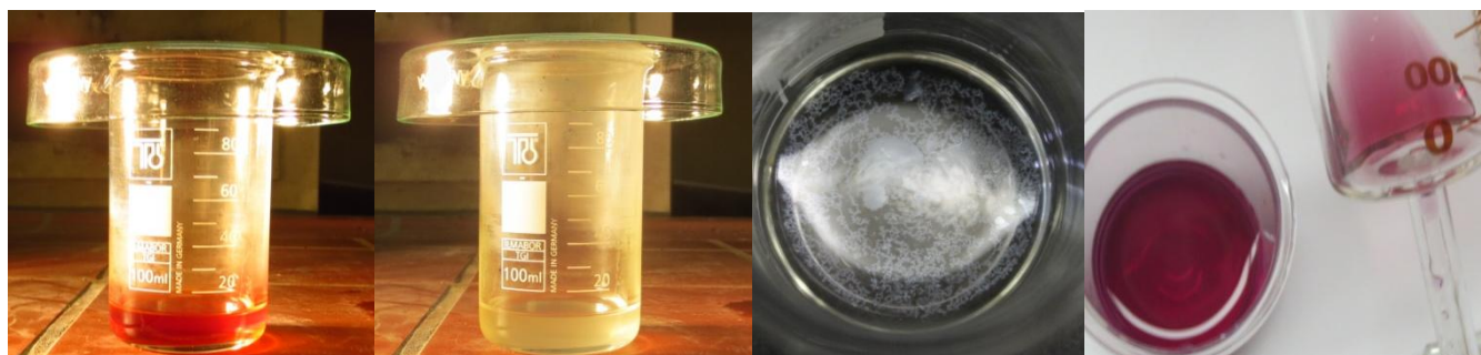
Abb. 4-7 – Bromlösung; Entfärbte Bromlösung; Ausgefallenes Silberbromid; leichte Rotfärbung der Lackmuslösung
