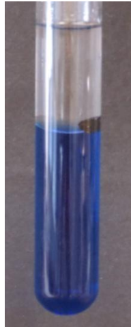
Abb. 8-9 - Phasengrenze zwischen Wasser [blau] und Heptan; Beobachtungen Versuchsteil 2
