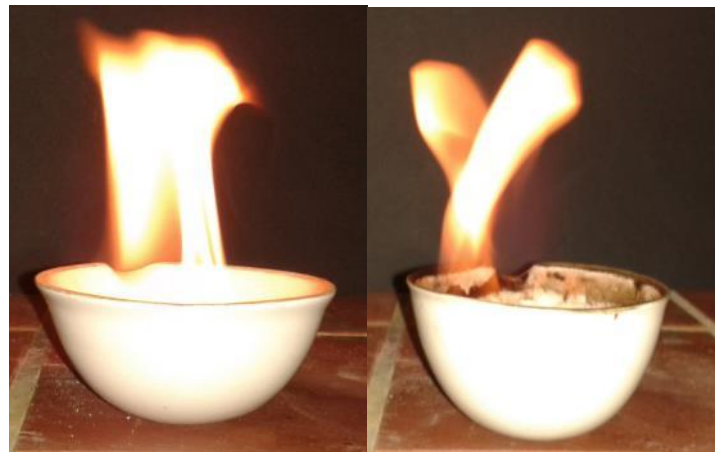
Abb. 2 – Flammenfarbe von angezündetem 1-Propanol (links) und Butan-1-ol (rechts)
