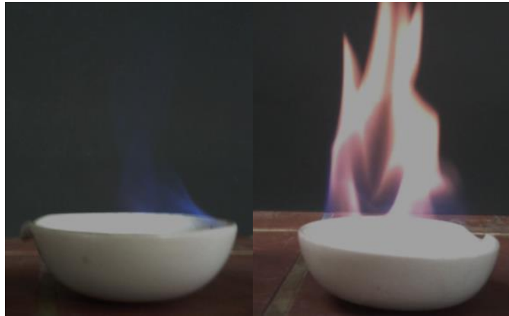
Abb. 1 – Flammenfarbe von angezündetem Methanol (links) und Ethanol (rechts).
