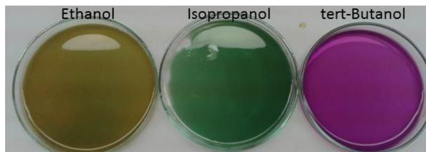
Abb. 6 – Oxidierbarkeit von Ethanol, Isopropanol und tert-Butanol mit Permanganat.
