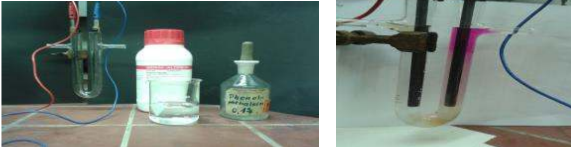
Abb. 2: Elektrolyse von Natriumchlorid
