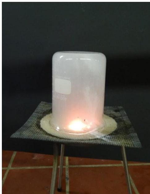
Abbildung 1: Versuchsaufbau für die Bildung von Magnesiumnitrid.
