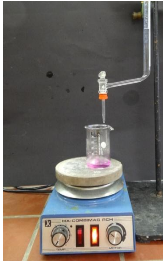
Abbildung 13: Versuchsaufbau für die Titration von Natronlauge mit Schwefelsäure.
