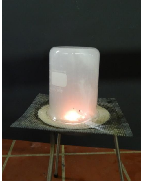
Abbildung 5: Versuchsaufbau für die Bildung von Magnesiumnitrid.
