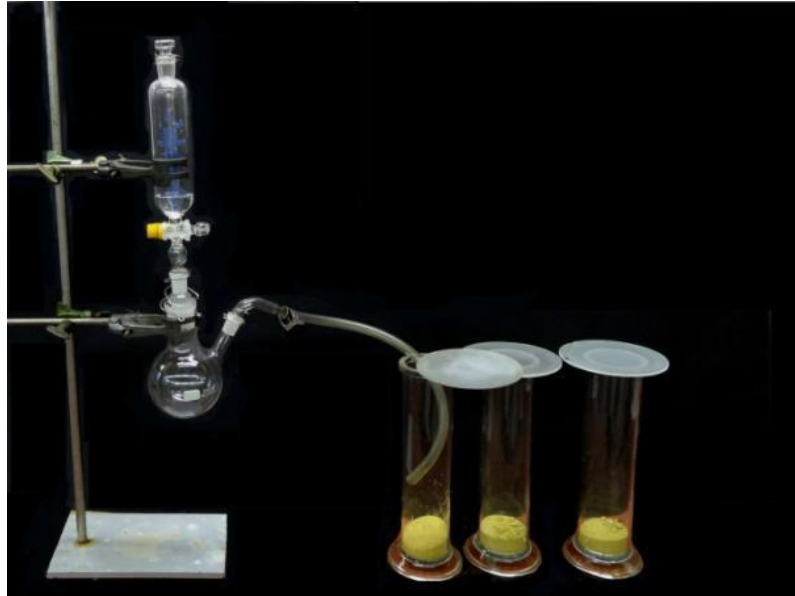
Abbildung 1: Der Versuchsaufbau für die Herstellung des Chlorgases.
