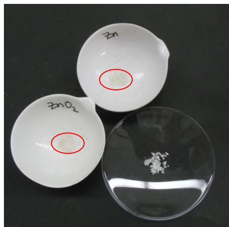
Abbildung 12: Der weiße, kristalline Rückstand der Lösungen von Zinkoxid (unten links) und Zink (oben rechts) in Salzsäure in den Porzellanschalen. Auf dem Uhrglas das Salz Zinkchlorid zum Vergleich.
