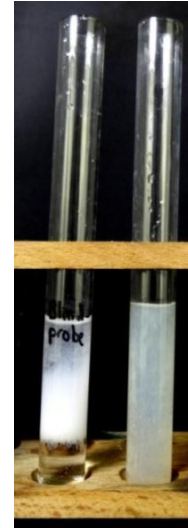
Abbildung 4: Die Blindprobe links und der positive Chlorid Nachweis rechts.
