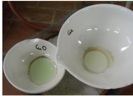
Abbildung 10: Die Lösungen von Kupfer (rechts) und Kupferoxid (links) in Salzsäure verfärben sich beim Eindampfen grün.
