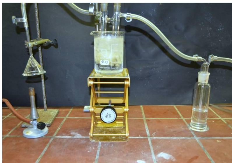
Abb. 1 - Versuchsaufbau „Analytischer Nachweis der Verbrennungsprodukte von Methan“.
