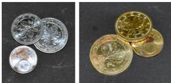
Abbildung 1: Münzen nach mehreren Minuten in der Zink-Hydroxid-Lösung (links) und nach dem Erhitzen in der Brennerflamme (rechts).
