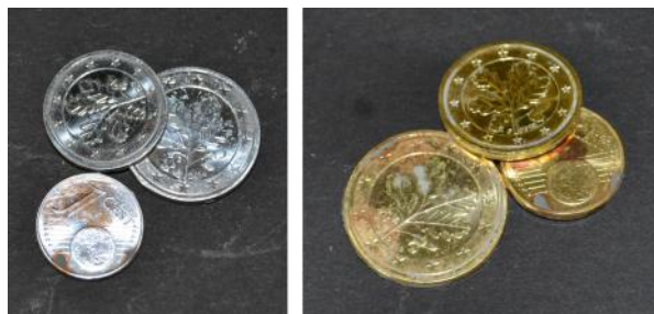
Abbildung 2: Münzen nach mehreren Minuten in der Zink-Hydroxid-Lösung (links) und nach dem Erhitzen in der Brennerflamme (rechts).
