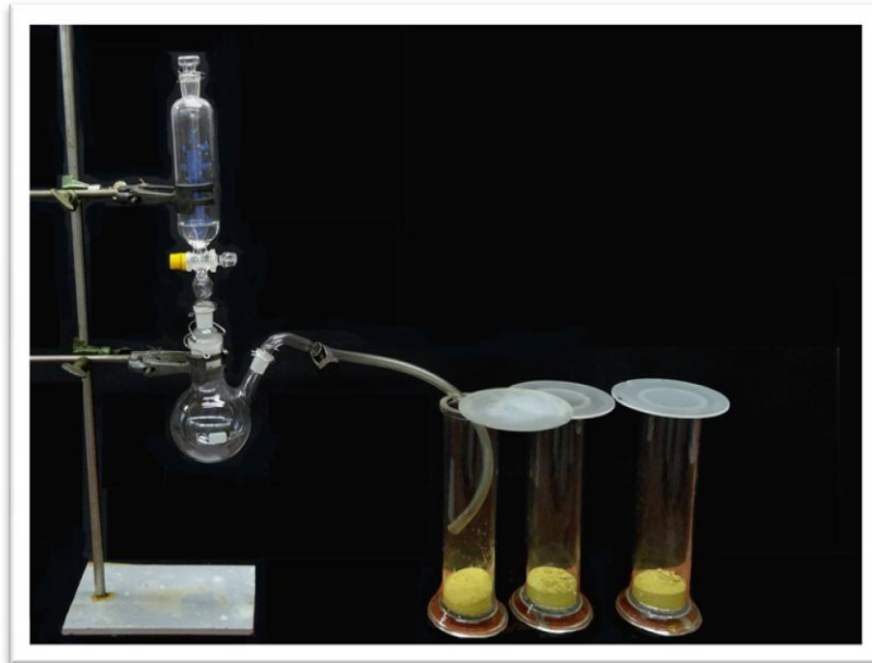
Abbildung 1: Versuchsaufbau der Gasentwicklungsapparatur
