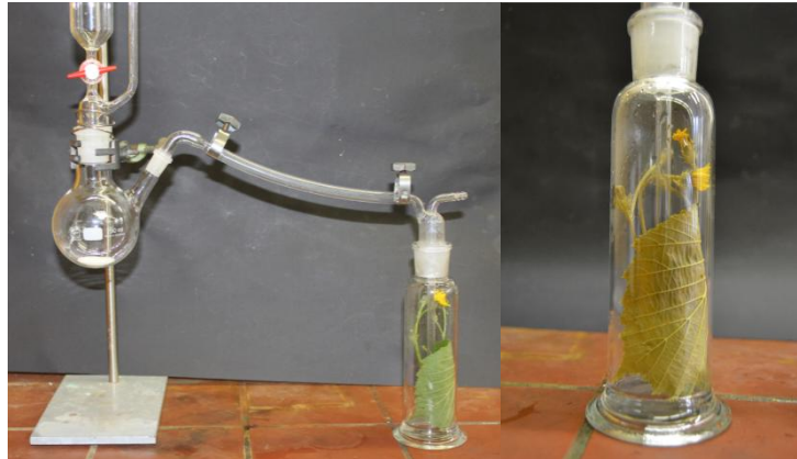
Abb. 1 - Der Aufbau der Apparatur und die gebleichten Blätter.
