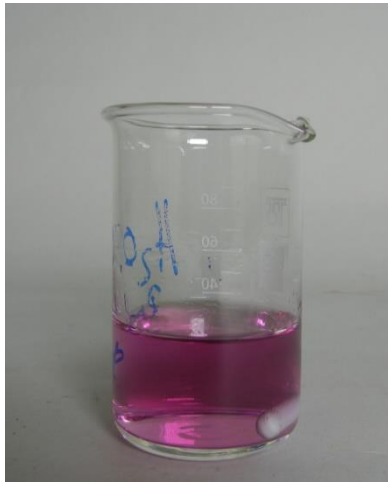
Abb. 1 Wasserprobe vor der komplexometrischen Titration (lila).
