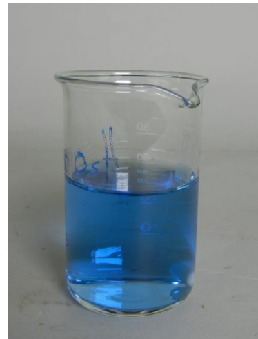
Abb. 2 Wasserprobe nach der komplexometrischen Titration (blau).
