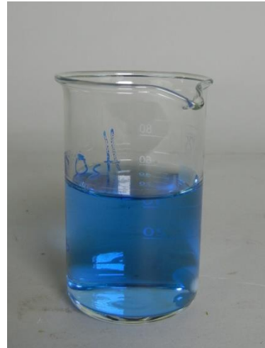
Abb. 2 Wasserprobe nach der komplexometrischen Titration (blau).
