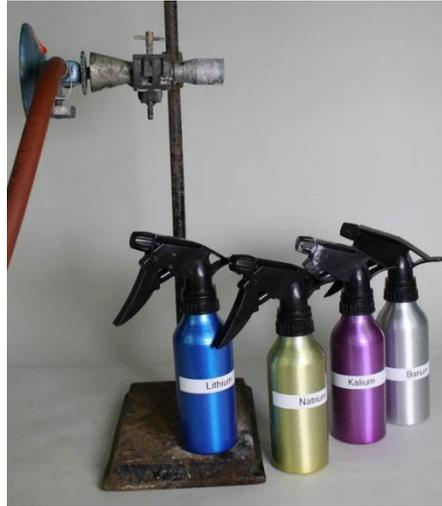
Abb. 1 - Versuchsaufbau für die Flammenfärbung.
