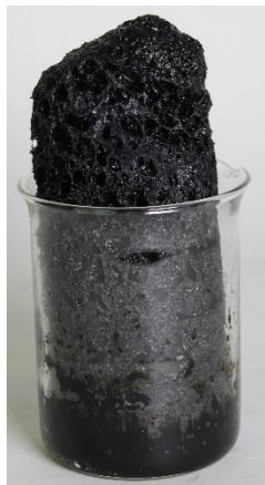
Abb. 1: Kohlenstoffgerüst nach der Reaktion von Schwefelsäure mit Zucker.
