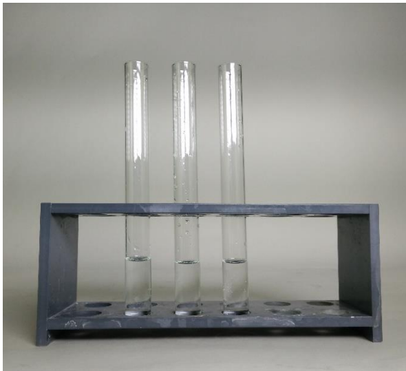
Abb. 2: Die farblosen Lösungen mit v.l.n.r. 5, 10 und 0 Vol.-% Ethanol weisen nach Cer(IV)-ammoniumnitrat-Lösung einen Farbveränderung von gelb nach rot auf. Die Vergleichslösung rechts weist nur die gelbliche Färbung des Nachweisreagenz auf.
