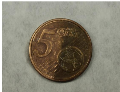
Abb. 2 - Cent-Münze nach Behandlung der einen Hälfte mit Essigessenz (links)
