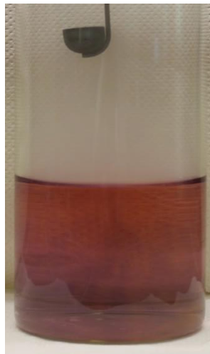
Abbildung 2 Die wässrige Lösung färbt sich von violett nach rot, bei Verwendung von Lackmus als Indikator. (oben ist die Lösung bereit rot und unten noch violett)
