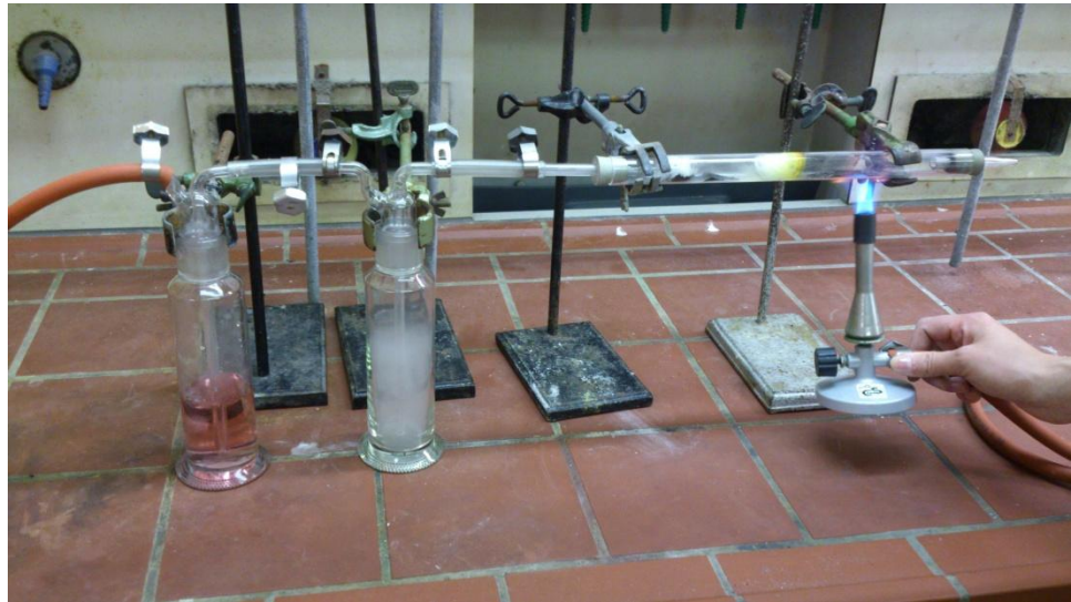
Abb. 2 - In Waschflasche eins bildet sich weißer Rauch. Die Lösung in Waschflasche zwei färbt sich rosa.
