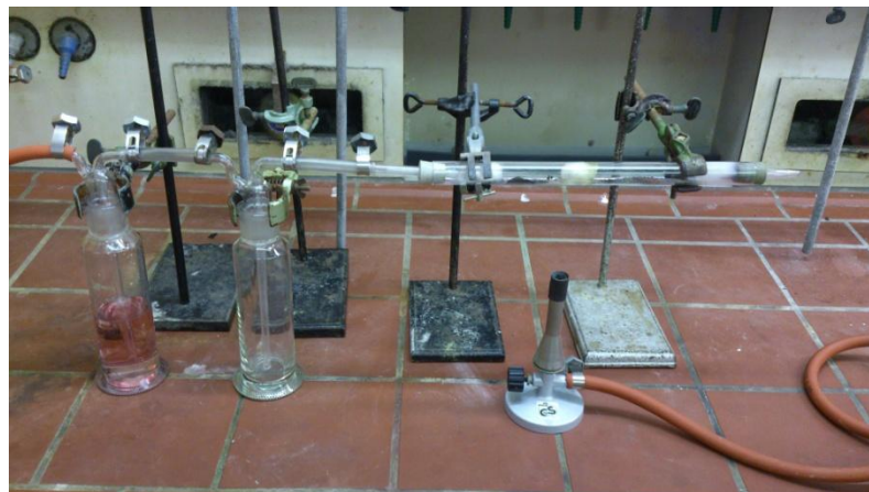
Abb. 1 - Versuchsapparatur zur Darstellung von Schwefelsäure nach dem Kontaktverfahren (Anmerkung: Die Apparatur müsste aus Gründen der Wahrnehmung eigentlich gespiegelt aufgebaut werden, dieser Aufbau war jedoch nicht möglich, da an der rechten Seite kein Vakuum gezogen werden konnte).
