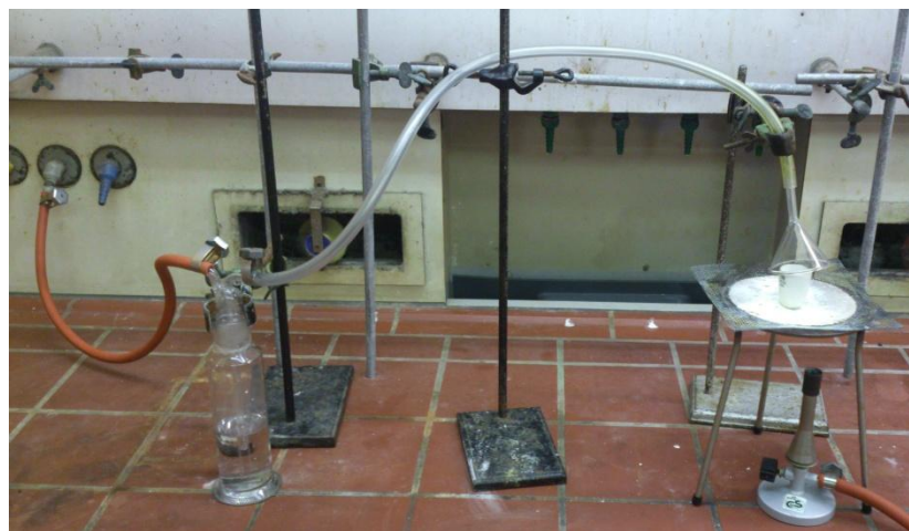
Abb. 5 - Apparatur zur Verbrennung von Schwefel mit Kaliumnitrat.
