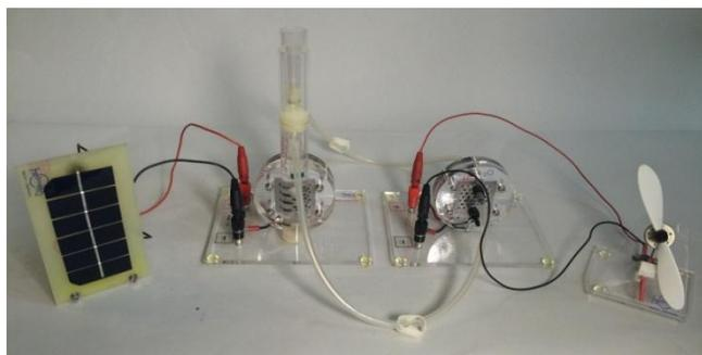
Abbildung 1: Aufbau des Experimentierkits zur Brennstoffzelle.
