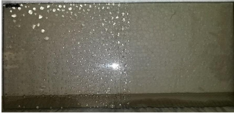
Abb. 1- links unbehandelte Seite und rechts mit TTIP-Lösung behandelte Seite.
