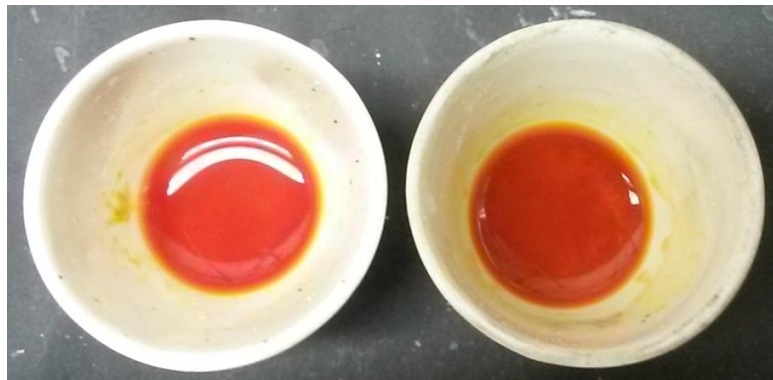
Abb. 4 – links Blindprobe und rechts indirekter Nachweis von Titandioxid nach Zugabe von Wasserstoffperoxid-Lösung.
