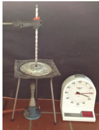
Abb. 4 – Versuchsaufbau zur Verfolgung der Temperatur des Wachses.
