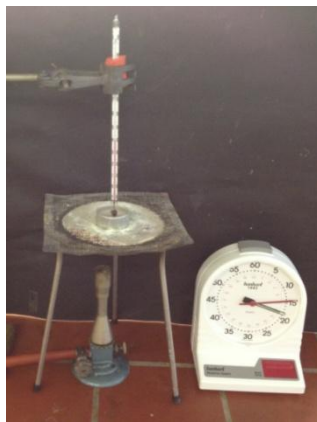
Abb. 4 – Versuchsaufbau zur Verfolgung der Temperatur des Wachses.
