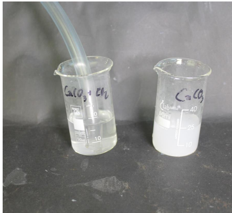
Abb. - Einleiten von Kohlenstoffdioxid in Calciumcarbonatlösung.
