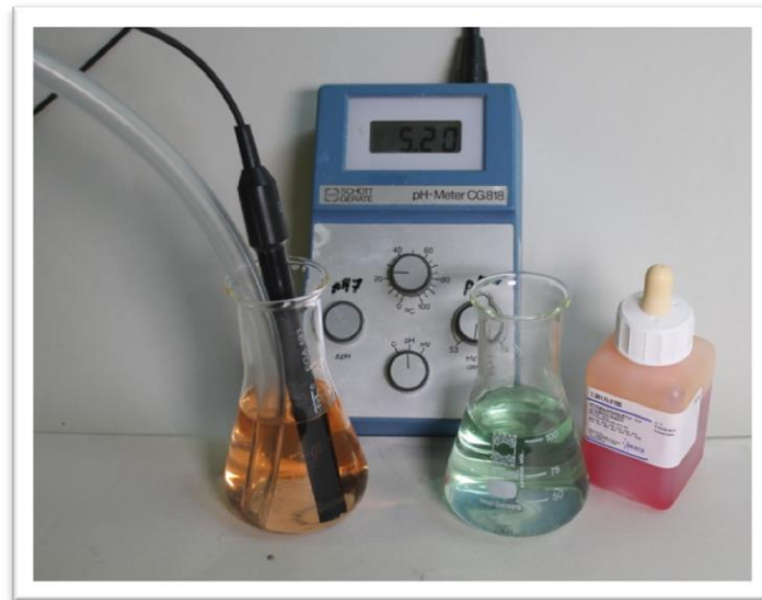
Abb. 2 - Links: Kohlenstoffdioxidgas wurde in Natriumchloridlösung eingeleitet. Der pH-Wert ist gesunken. Rechts: pH-neutrale Vergleichslösung.
