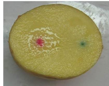
Abbildung 1: Farbveränderung bei der „Kartoffelektrolyse“
