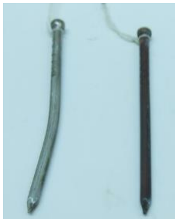
Abb. 4 – Eisennagel vor (links) und nach dem Verkupfern (rechts)
