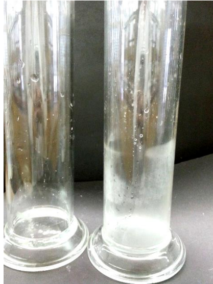
Abbildung 1 – Links: Mit destilliertem Wasser ausgewaschener Standzylinder. Rechts: Mit einer Calciumhydroxid-Lösung befeuchteter Standzylinder.
