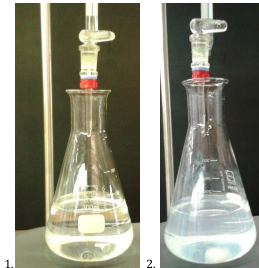
Abb. 1 - Darstellung der Natriumchlorid-Lösung vor einem schwarzen Hintergrund. 1. Vor der Titration. 2. Nach der Titration, wo die erste Trübung aufgetreten ist.
