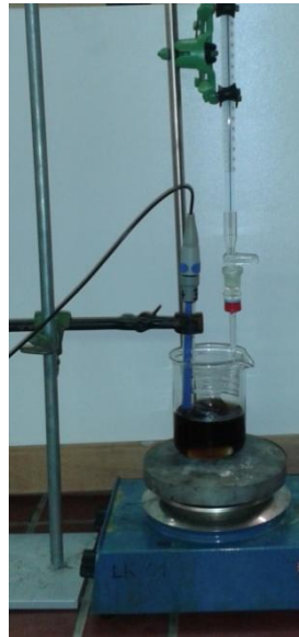
Abbildung 3: Darstellung des Versuchsaufbaus der Titration von Cola.
