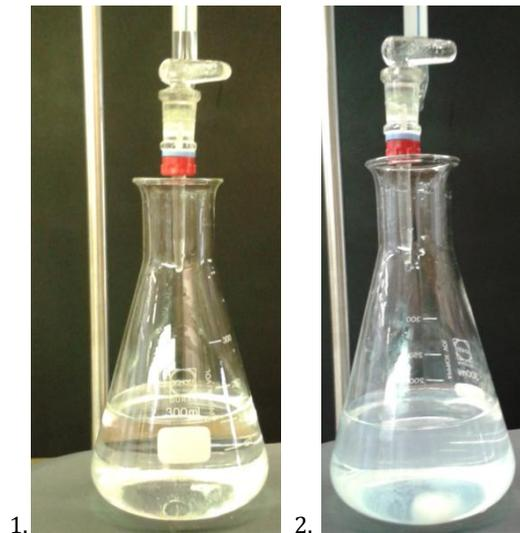
Abb. 1 - Darstellung der Natriumchlorid-Lösung vor einem schwarzen Hintergrund. 1. Vor der Titration. 2. Nach der Titration, wo die erste Trübung aufgetreten ist.
