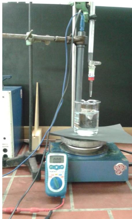
Abbildung 2: Versuchsaufbau der Leitfähigkeitstiteration.
