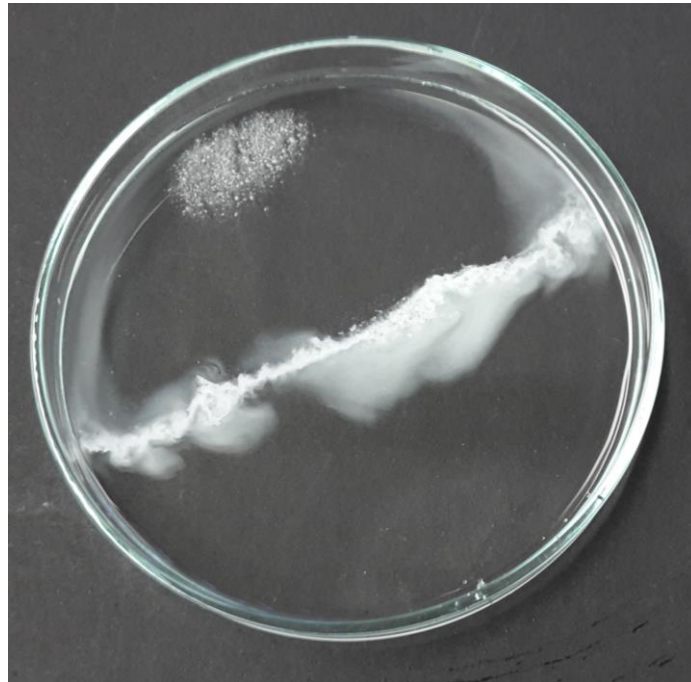
Abbildung 1: "Riff"/Calciumcarbonbildung an der Reaktionsfläche zwischen Natriumcarbonat-Decahydrat (unten) und Calciumchlorid-Dihydrat (oben).
