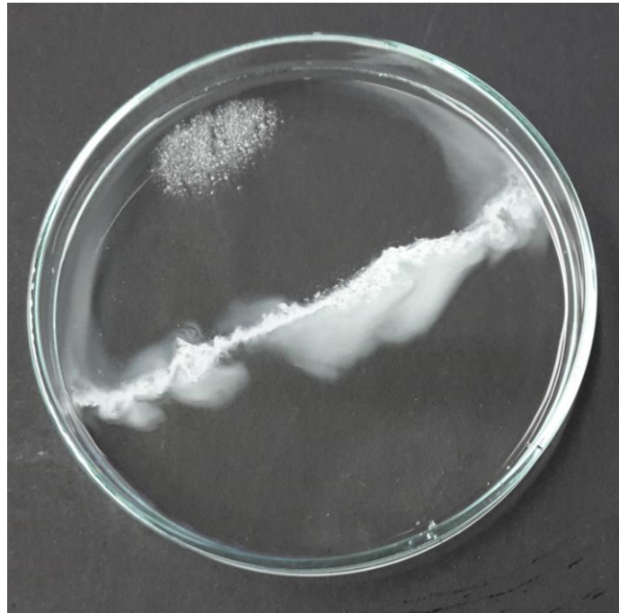
Abbildung 5: "Riff"/Calciumcarbonbildung an der Reaktionsfläche zwischen Natriumcarbonat-Decahydrat (unten) und Calciumchlorid-Dihydrat (oben).
