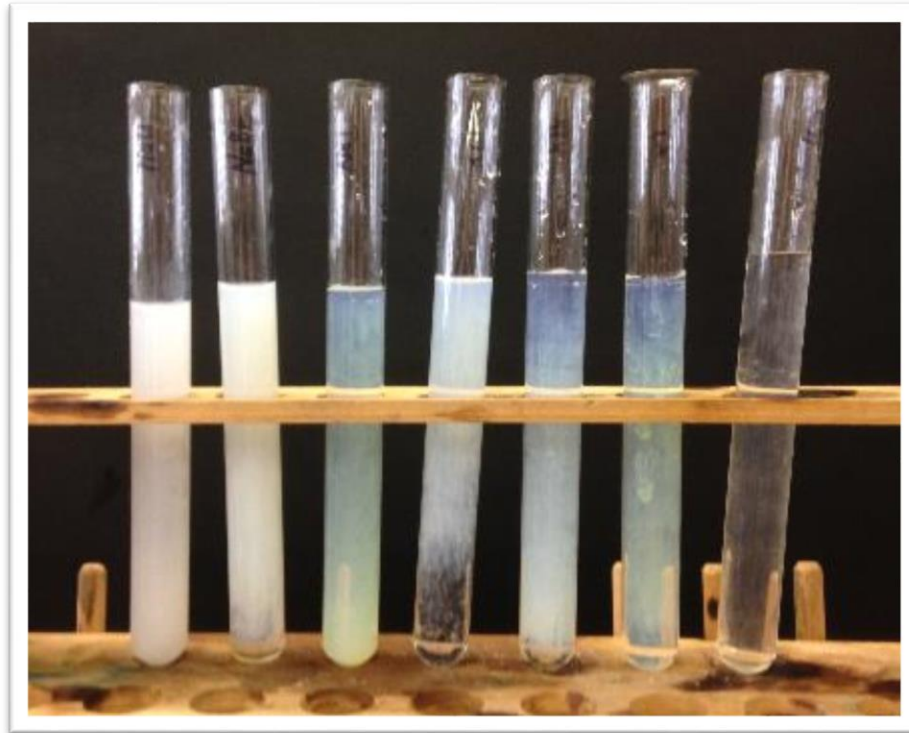
Abb. 4 – Halogenid-Nachweis mit Silbernitrat (von links: Natriumchlorid, Natriumbromid, Natriumiodid, Kaliumchlorid, Kaliumbromid, Kaliumiodid, Wasser).
