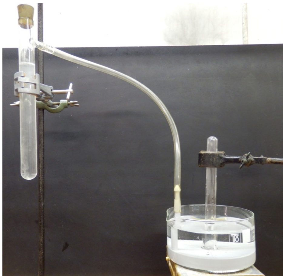
Abbildung 2: - Geräteanordnung mit Reagenzglas mit Ansatz und pneumatischer Wanne zum Auffangen des entstandenen Wasserstoffs.
