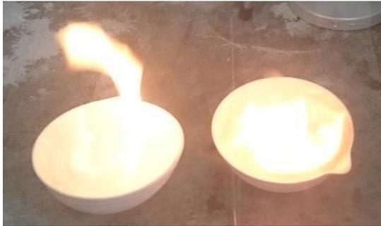
Abbildung 1: Brand von Heptan (links) und Petroleumbenzin (rechts)
