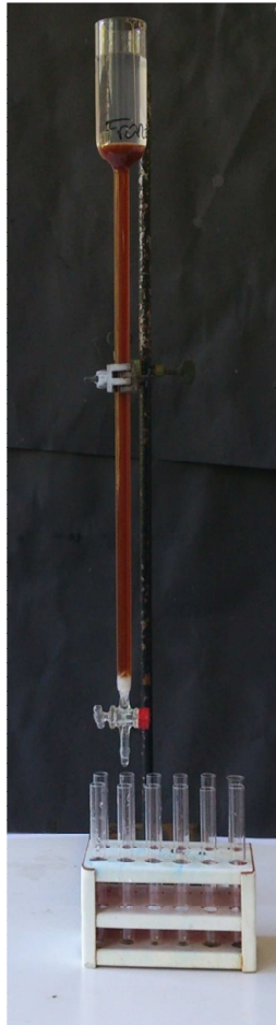
Abb. 1 - Versuchsaufbau für den Versuch „Wasserenthärtung, fast wie in der Spülmaschine.“
