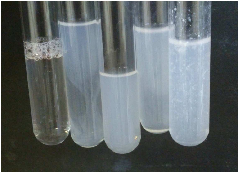
Abb. 6 - Lösungen nach dem Zutropfen der Seifenlauge, von links nach rechts folgende Proben: Destilliertes Wasser, Leitungswasser, Vilsa, evian, Leinewasser
